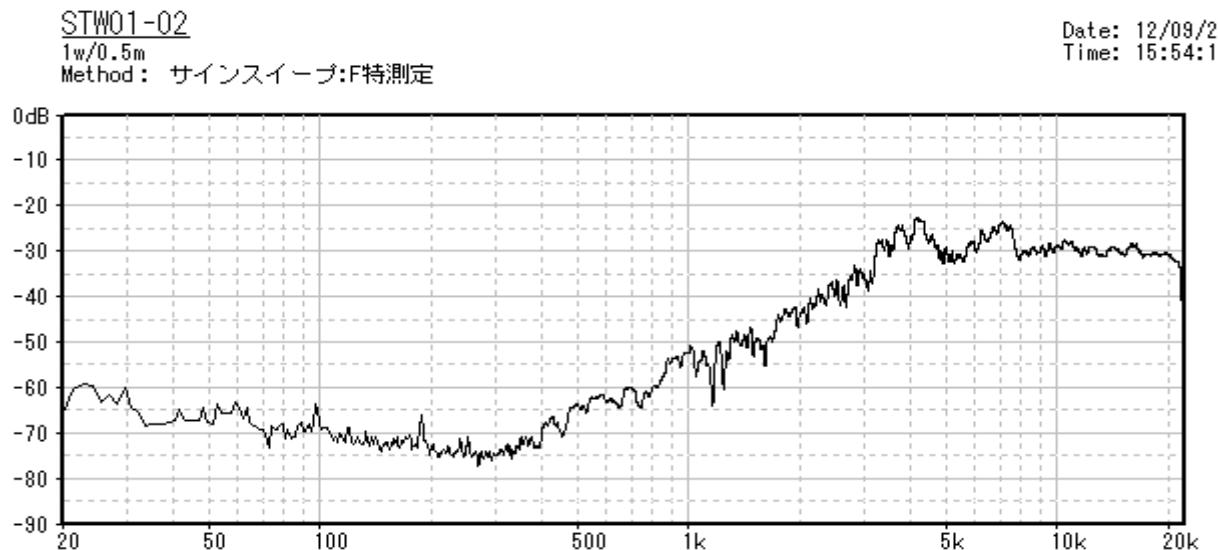
TV用のツイーター特性例 (20kHz 以下で急激に減衰しています)
