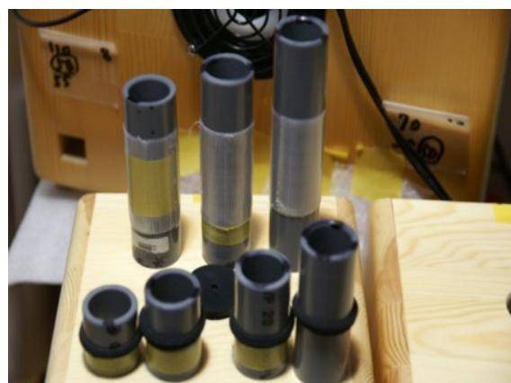
片側4個でユニット付が1個、長さの異なる塩ビ管ポートで自由に接続し各種多自由度バスレフを実験できます。
