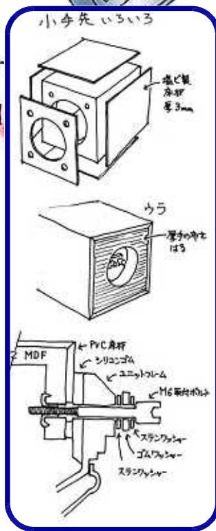
ダンピングと振動系のフローティング化のため、シリコングムを流し込む
