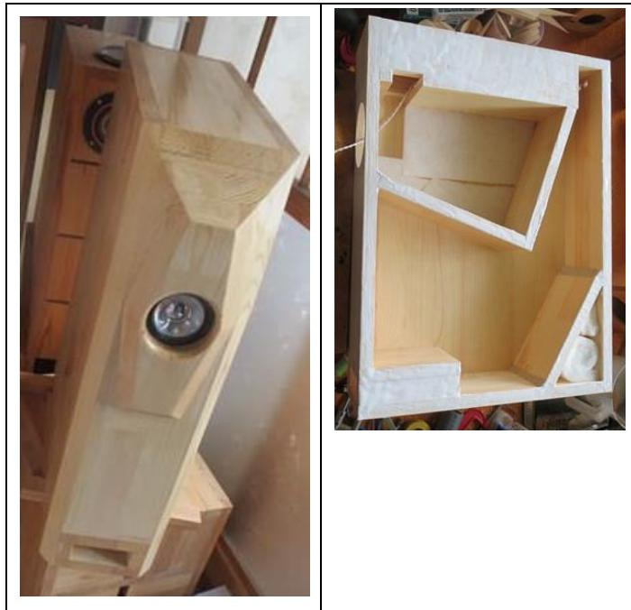
スロートで低音が減衰しないように、スロートをあまりつぶれない形にしました。音工房 Z で一部のスピーカーに使われていた VW(バリアブル・ワイドス)方式です。
