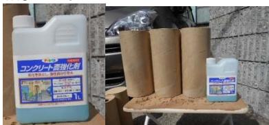
ボイド管自体の補強には「コンクリート面強化剤」を用いた。原材料は水溶性ケイ酸塩であり、作用は「コンクリート面に浸透してガラス質の強化層を形成し、耐摩耗性の向上、劣化防止、防塵に優れた効果があります。(アサヒペン HP より)」とのことである。これを塗り込むことで感材量自体の硬化を図った。
