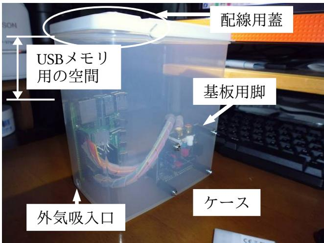
裸で配線して動作確認した後にケースに組込む
