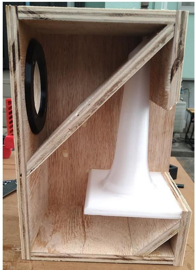
こちらが本題ですが、ジャンクユニットにありがちなL型形状の固定を3Dプリンターでアタッチメントを作成することで容易かつ強固にバッフルに固定しました。バッフル裏面にアタッチメントを接着する構造でバッフル自体の補強も兼ねています。ユニット毎に専用の物を作る必要がありますが3Dプリンターは少量作成に適したツールです。
