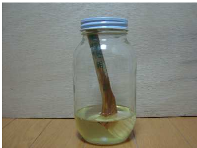
写真2 適当な大きさの瓶と筆 (薄めたラッカーをこのように入れておく)
