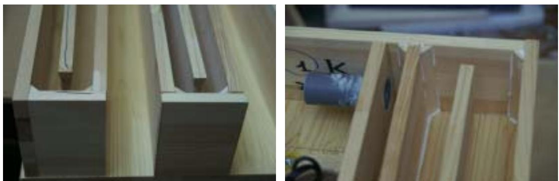
ターン部分は三角棒でカーブをつけて、第一ターン以後は2cmずつ音道高さを増して少しだけラッパをつけています。
