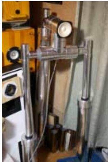
塩ビ管 3重パイプによる同軸ターンは、入手しやすいサイズのパイプで、折り返しごとに断面積が増してゆくようになると、意外にパイプサイズの選択肢が広くありません。ところで塩ビ管の内径サイズは実際には公称名よりだいぶ大きいことがあります。内径、外径の実測値から断面積計算をして、折り返しごと広がるようになる組み合わせを選びます。スタートから VP40、VU65、VU100 としました。
