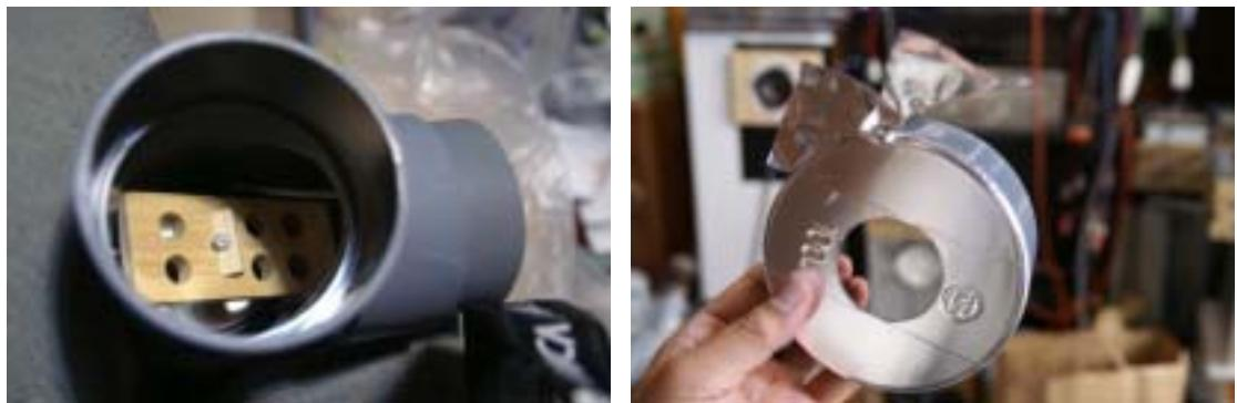
VU100CAP と VP40 の隙間はスポンジパイプで O リングを作ってはさみます
