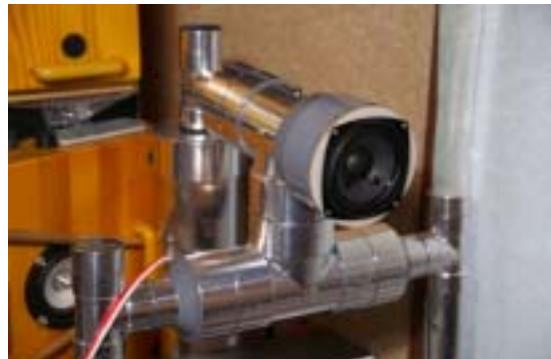
長管は高さ違いの合わせにプロックを敷きます ユニットは低発泡塩ビシートでパッキン取り付けしました
